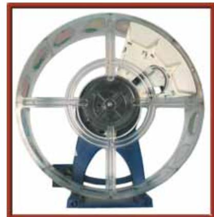
**Nota :** En el soporte tambor se indican marcas cada 5 grados. La posición inicial es -1 y +1 (no existe la posición 0) y cada paso supone un desplazamiento de 2 grados.
